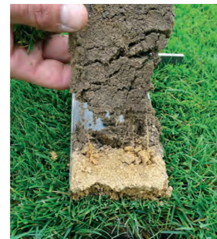
Prüfung der Durchwurzelung mit Profilspaten.
